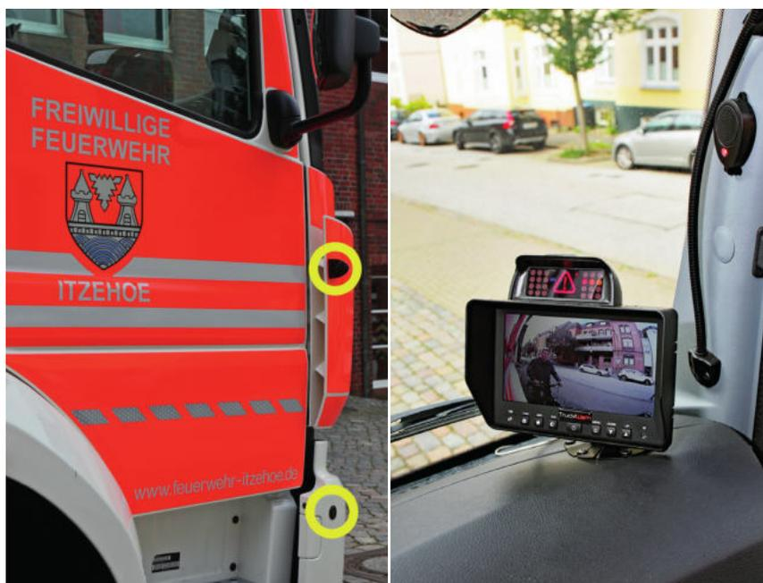
Dank der Kamera-Software-Technik können zum Beispiel Radfahrer im toten Winkel erkannt und auf einem Monitor angezeigt werden.
