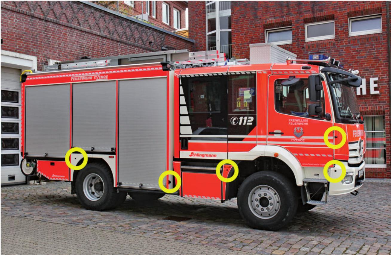
Kameras und Sensoren des Breitenberger Assistenzsystems »Truck!Warn«
